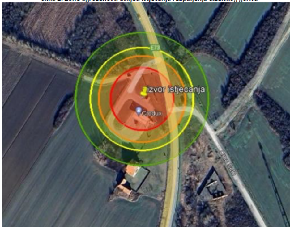
Slika 2: Zone ugroženosti uslijed istjecanja i zapaljenja dizelskog goriva
